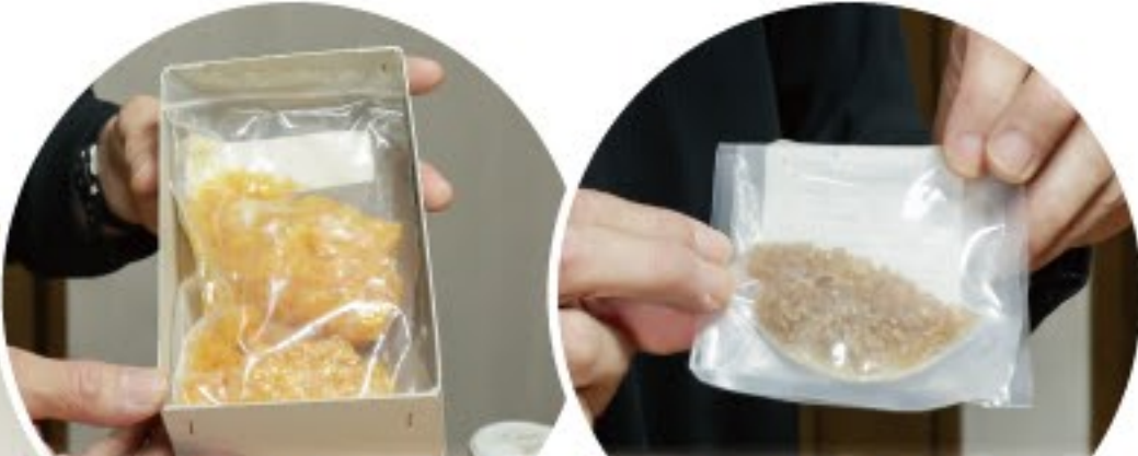
接着には膠（にかわ）を使う。湯煎をして一定の温度に保たなければならないなど、楽器用ボンドの3、4倍も手間がかかるが、硬質のため振動の伝達性が高い。
